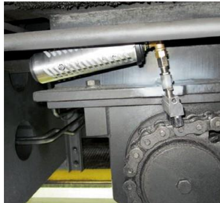
simalube 250 ml 자동주입기는 레일 크레인의 구동 체인을 윤활하며, 보호 커버가 자동주입기를 보호합니다.
