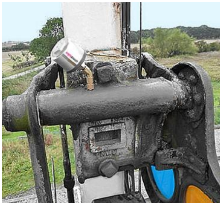
철도 신호기의 플레잉 베어링은 simalube 30 ml 자동주입기에 의해 자동 윤활됩니다.
