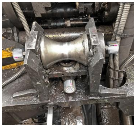
simalube 30ml 자동주입기는 측면 베어링과 가이드 롤러의 리프팅 장치를 윤활합니다.
