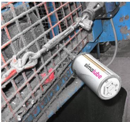
외부에 설치된 simalube 자동주입기는 먼지가 윤활 지점으로 들어가는 것을 방지합니다.
