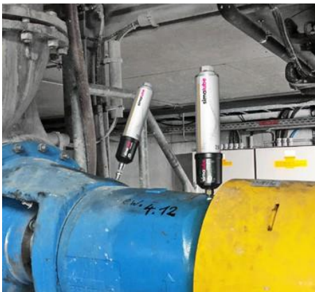
펌프의 베어링은 두 개의 IMPULSE 및 simalube 250ml 자동주입기로 윤활됩니다.
